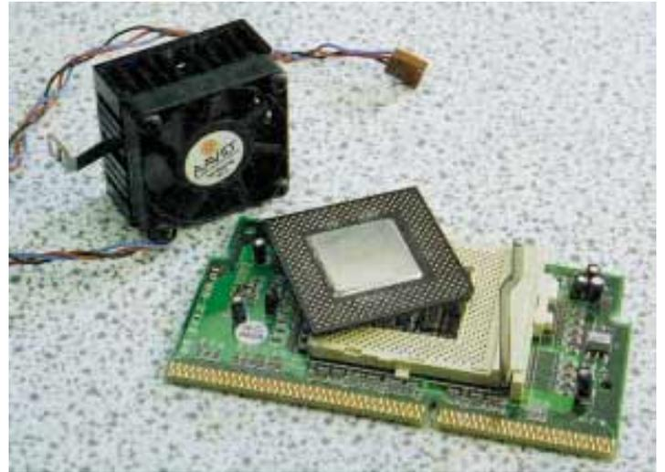
*Ecco un processore col suo zoccolo ed il dispositivo di raffreddamento. Come accennato, le alte velocità con cui la corrente elettrica (per raggiungere elevate potenze di calcolo) percorre il processore causano il surriscaldamento di quest'ultimo. È necessario provvedere al suo raffreddamento tramite dissipatori di calore e ventole di raffreddamento, troppo spesso rumorose oltre il limite del disturbo.*
