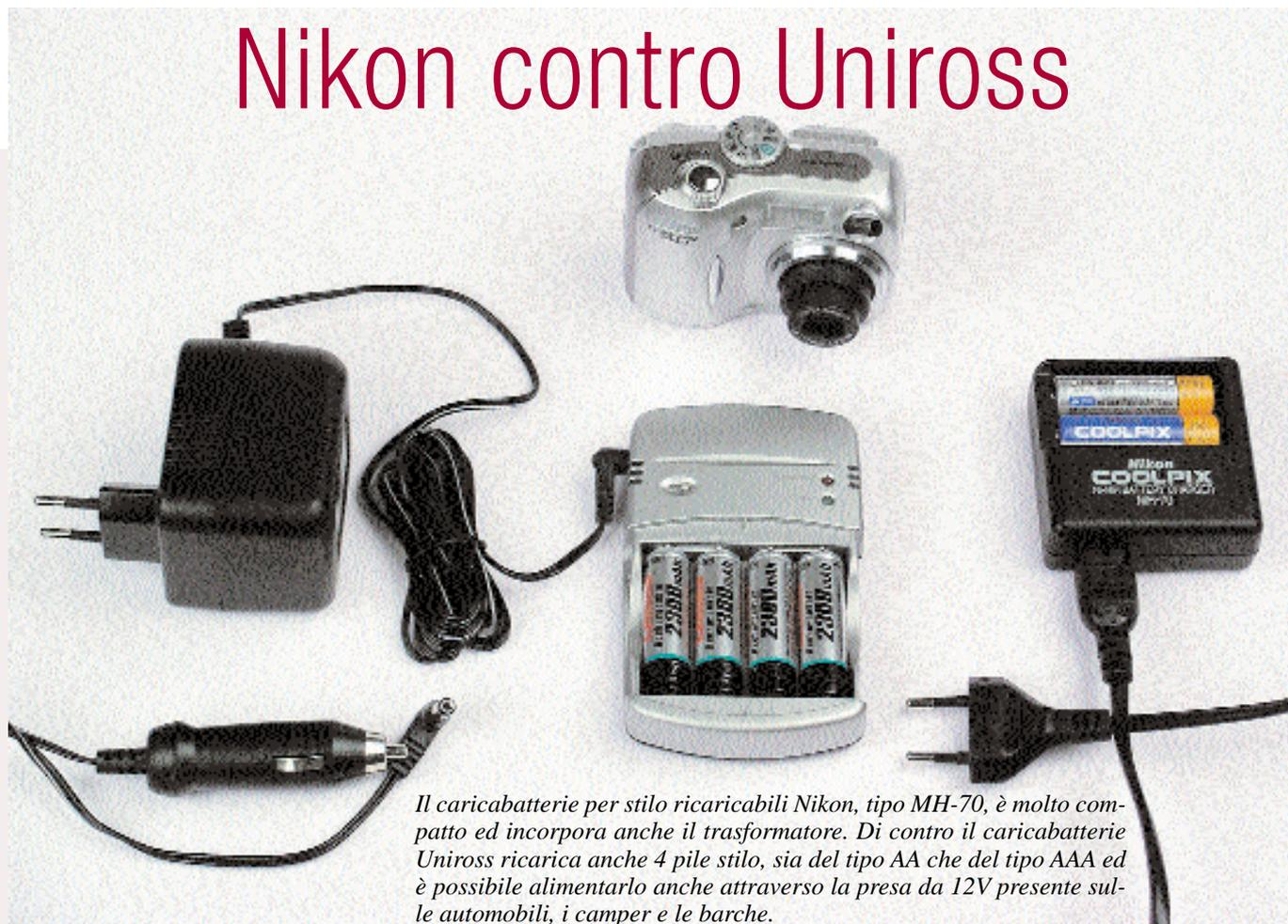
*Il caricabatterie per stilo ricaricabili Nikon, tipo MH-70, è molto compatto ed incorpora anche il trasformatore. Di contro il caricabatterie Uniross ricarica anche 4 pile stilo, sia del tipo AA che del tipo AAA ed è possibile alimentarlo anche attraverso la presa da 12V presente sulle automobili, i camper e le barche.*
